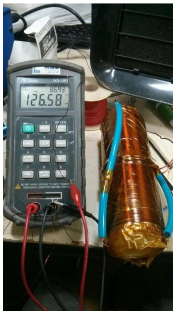
Figura 24: Medindo a indutância da bobina pronta para ser resfriada [Fonte Própria]
