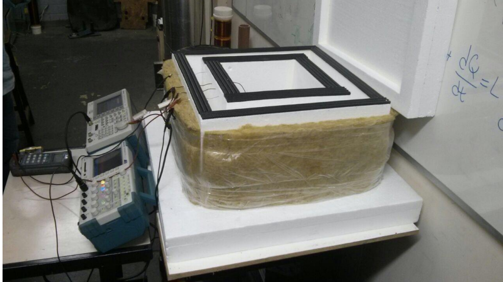
Figura 25: Imagem mostrando como a fiação foi conectada entre a bobina e os instrumentos de medição. [Fonte Própria]
