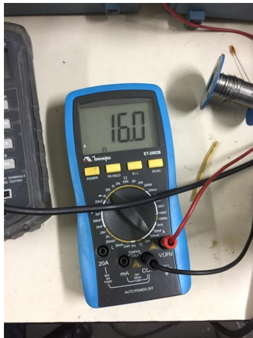
Figura 23: Medindo a resistência total da bobina com três camadas já dentro do compartimento interno [Fonte Própria]
