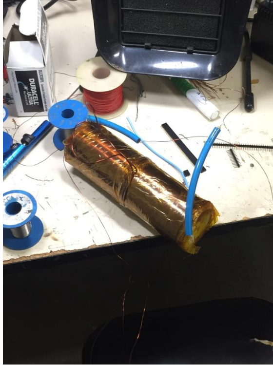
Figura 22: Bobina após a finalização da terceira camada e já coberta pelo kapton.
