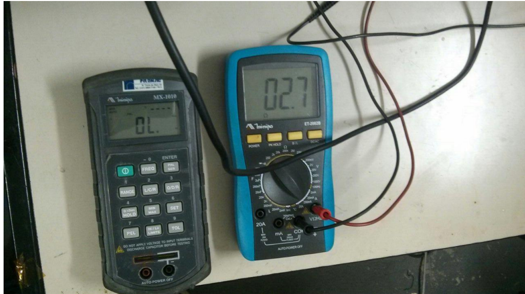
Figura 31: Multímetro indicando o valor da resistência elétrica obtida durante o segundo teste. [Fonte Própria]
