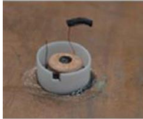
Figura 5: Revestimento de PTFE envolvendo uma bobina Toroidal como parte da estrutura do experimento em [4].
